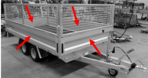
Bei der Schließung von den unteren Seiten des Anhängers sowie die Bordwände vorne / hinten, könnte es erforderlich sein, den Winkel auf den untere Schlossbeschläge und Halteplatten mit einem Gummi Hammer anzurichten. Siehe die gezeigte Beschlag Typen und Platten auf untenstehendes Foto. Dadurch wird gesichert, dass die Netzseiten/Plattenseiten, als ob die Bordwände vorne / hinten mit den unteren Seiten des Anhängers parallel schließen.
