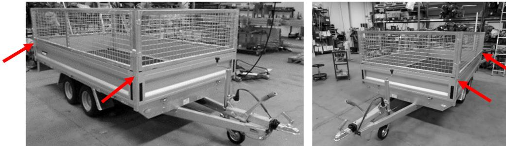
In den Fällen wo es viele Montagen bzw. Abmontagen gibt, müssen die gewindeschneidende Schraube als auch der Gewinde auf dem Netzgitter/Platten Eckpfosten gegen Verschleiß überprüft werden. Bei sichtbarem Verschleiß oder falls Sie beim Festspannen fehlende Vorspannung spüren, müssen Schrauben und Netzgitter/Platten Eckpfosten ausgewechselt werden.
