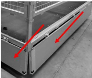
2. Montieren Sie alle 4 Stück Netzgitter/Platten Eckpfosten, in dem die Netzgittern/Plattenseiten festgemacht werden, in den 4 untere Eckpfosten des Anhängers. Falls in den untere Eckpfosten des Anhängers Kunststoffstopfen montiert sind, müssen sie entfernt werden bevor das Netzgitter/Platten Eckpfosten montiert werden kann. Siehe Foto unten.
