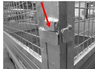
**Nachprüfung bevor Beginn der Montage:** Falls Sie Galvanisierungsreste in den Schienen (Scharnier Bolzen oder Netzgitter/Platten Eckpfosten Schienen) finden, müssen diese Reste mit schleif Werkzeug oder Meißel vor der Montage entfernt werden.
